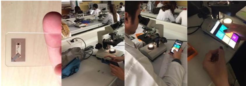
Figura 1. Imágenes de los portaobjetos con el chip NFC y su utilización en la práctica en el Aula de Microscopía
